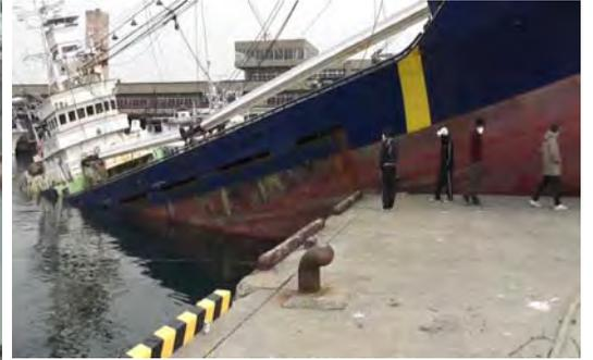
船着き場のコンクリートをVの字にえぐり取り船尾が沈没(上)
